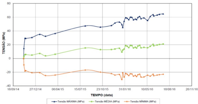
Figura 9.24 Gráfico de la variación de la tensión a lo largo de 2 años
