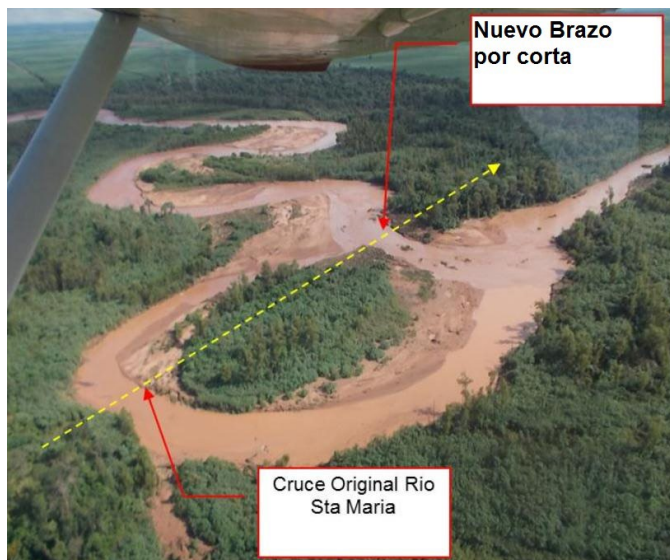
Figura 4.27 Cambio de curso por corta de meandro en un río de piedemonte, previo a la desembocadura Fuente: Transportadora de Gas del Norte
