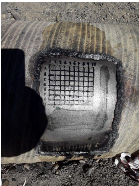
Figura 9.51: Grilla de evaluación de fallas y medición de espesores
