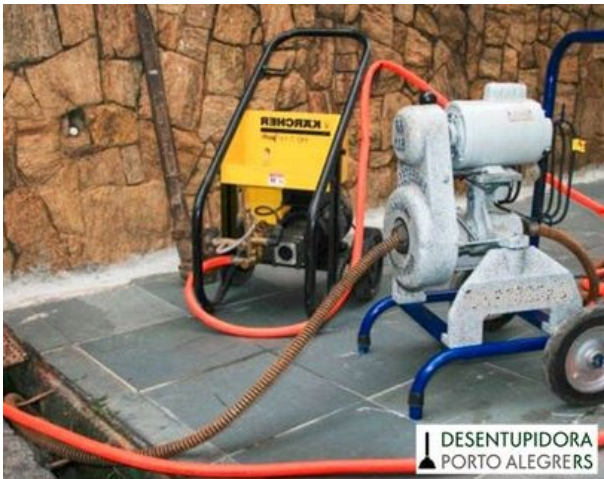
Figura 6.14 Típico equipamiento de desobstrucción de ducto de desagüe (izquierda). Raíces retiradas en el proceso de limpieza (derecha)
