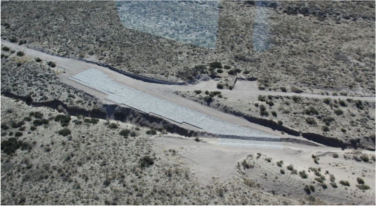
Figura 3.10: Ejemplo de recuperación de DDV. Mendoza, Argentina (previo al paso de la Ruta Nacional 40)
