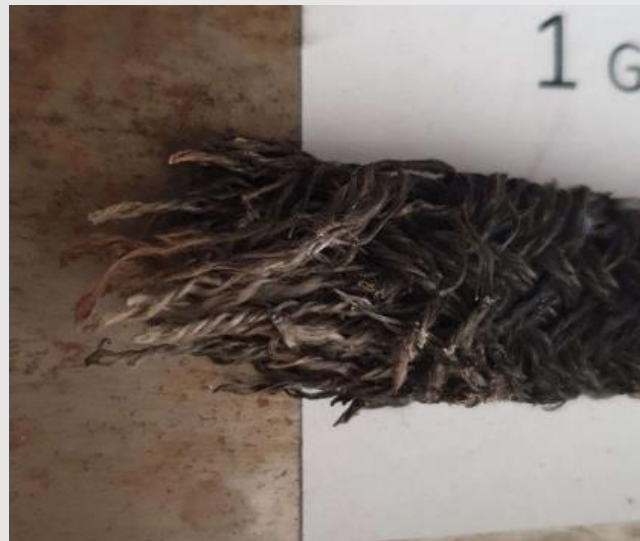
Soga de grafito (se degradó y se aplastó)
