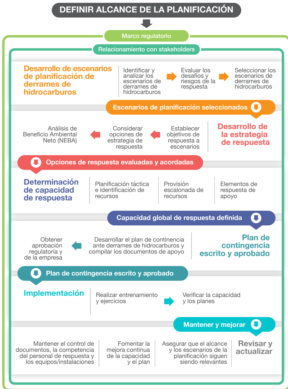
Figura 2 - El desarrollo, la aplicación y el mejoramiento de los planes son las piedras angulares del programa de EP&PR (adaptado de Ipieca, 2016)
